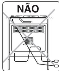
Não é permitido o uso de extensões e conectores tipo T (benjamim), para evitar mau contato, aquecimento, curto-circuito, derretimento, etc.
