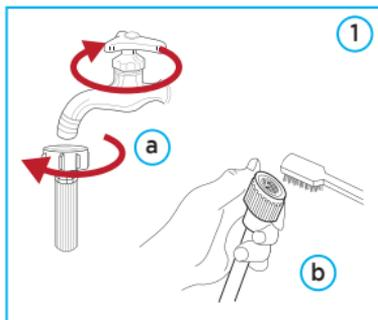
3. Limpe o filtro com água corrente até que fique totalmente desobstruído e isento de partículas ("b" - fig. 1). Evite que a sujeira seja jogada para o interior da mangueira.
